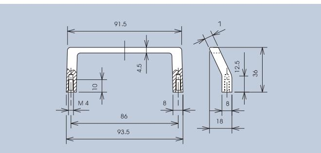
Einschließlich Zylinderschrauben-M4 x 10 und Scheiben.
