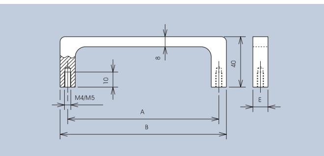
Einschließlich Zylinderschrauben-M4 x 12 bzw. M5 x 12 und Scheiben.
