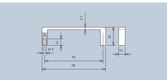
Einschließlich Zylinderschrauben-M5 x 12 und Scheiben.
